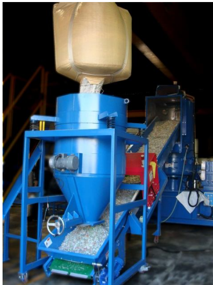
原料投入貯蔵タンク・投入の様子
