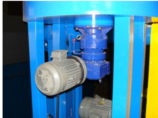
横入れ式貯蔵タンク動力部
